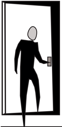
Left hand: hinges on left, opens inward
